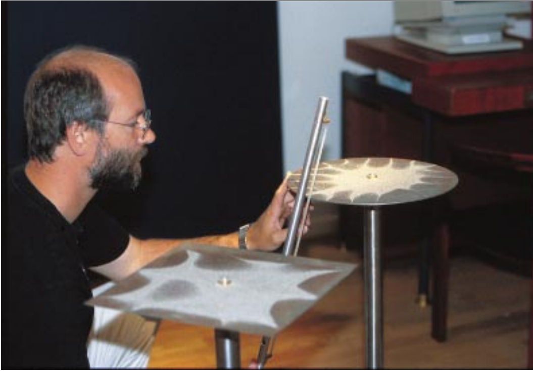
Hans Buhl demonstrerer, hvordan sand på en metalplade ordner sig i sirlige klangmønstre, når man stryger på kanten med en violinbue. Mønstrene opstår fordi sandet samler sig langs de såkaldte "knudelinier", hvor pladen ikke svinger.
